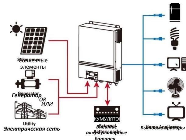
**Рисунок 1. Общая схема гибридной фотоэлектрической системы**
