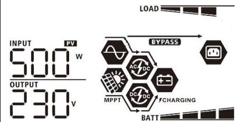
Мощность фотоэлектрической панели 1 = 500 Вт (модели с двумя входами)
