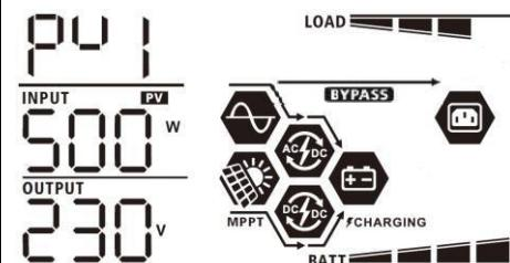
Мощность фотоэлектрической панели 2 = 500 Вт (модели с двумя входами)
