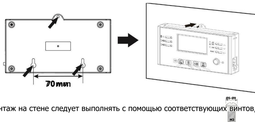
**Примечание.** Монтаж на стене следует выполнять с помощью соответствующих винтов, показанных на рисунке справа.
