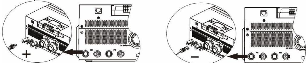
**ОСТОРОЖНО!** Для безопасной и эффективной работы очень важно для присоединения фотоэлектрического модуля использовать соответствующие кабели. Во избежание травмы используйте кабель соответствующего типоразмера (см. следующую таблицу).
